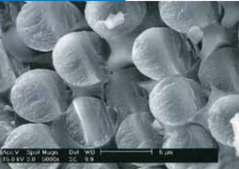
Vue au microscope électronique des fibres agglomérées dans la matrice Epoxy
