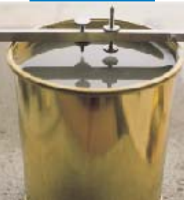
Essai d'expansion libre en phase plastique selon UNI 8996/89
